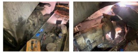
งานเชื่อม Locket Arm Coal mill
