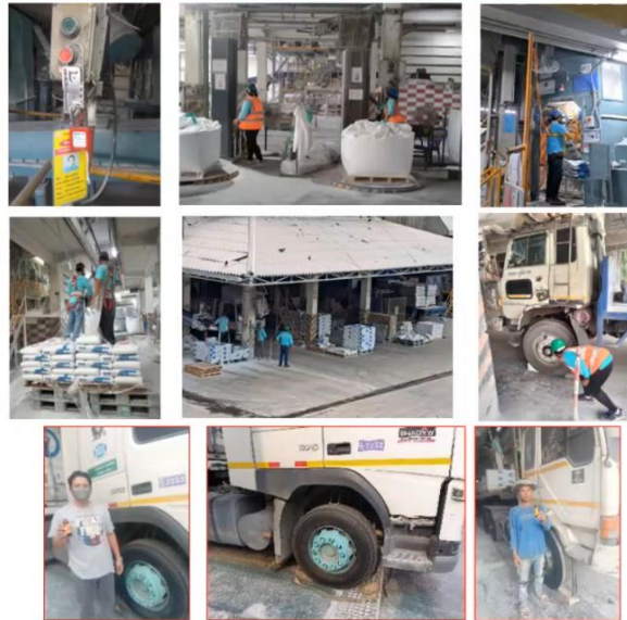
ติดตามรถลูกค้าจ่อรับสินค้า ดับเครื่อง และ หนุนล้อ ป้องกันรถไหล มีการให้รางวัลกับคนขับรถที่ปฏิบัติ
